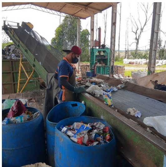
Figura 83: Esteira de triagem de resíduos recicláveis na UTR.
