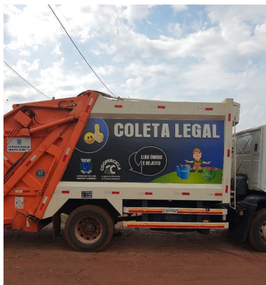
Figura 72: Caminhão compactador para a coleta de resíduos convencionais.
