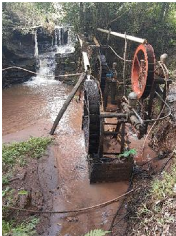
Figura 138: Rodas d'água para abastecimento de residência no assentamento Magno de Oliveira.
