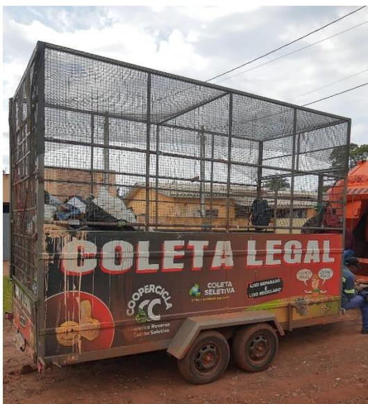
Figura 73: Reboque para a coleta seletiva acoplado ao caminhão compactador.
