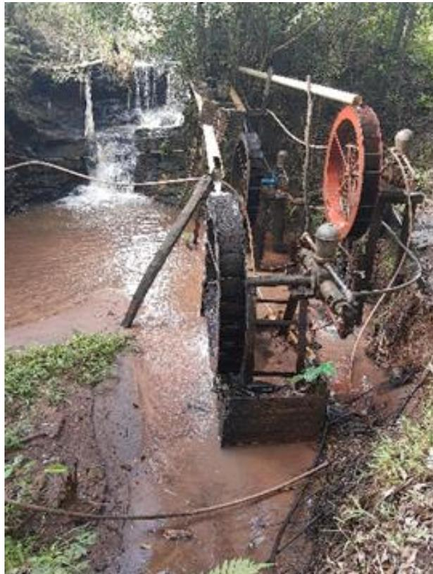
Figura 136: Rodas d'água para abastecimento de residência no assentamento Magno de Oliveira.
