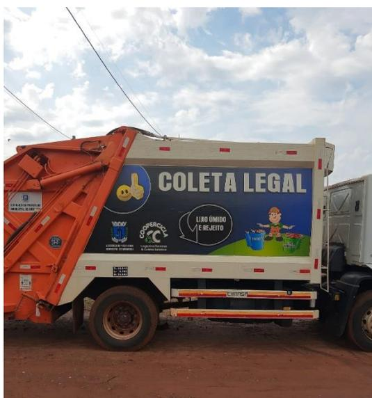
Figura 70: Caminhão compactador para a coleta de resíduos convencionais.
