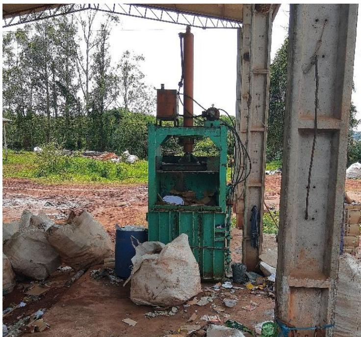
Figura 83: Prensa mecânica para enfardamento de materiais recicláveis.
