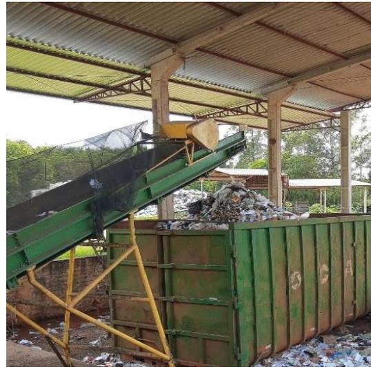
Figura 82: Contêiner para coleta dos rejeitos resultantes da triagem de resíduos recicláveis.
