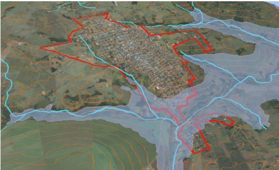
Figura 95: Simulação de Evento extremo de inundação.
