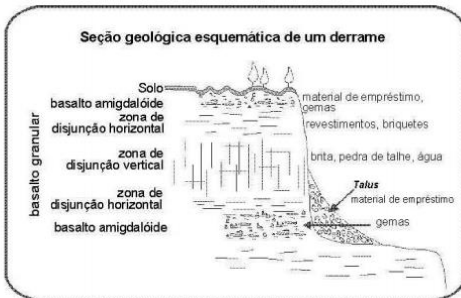
Figura 5: Seção geológica esquemática de um derrame. Fonte: CPRM.
